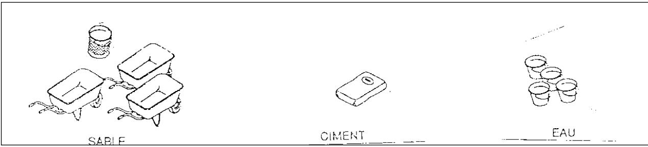
Le mortier pour la fabrication des parpaings ordinaires compactés à la main est dosé à 250 Kg/m<sup>3</sup>. Pratiquement on utilise 1 sac de ciment, 4 brouettes de sable et environ 40 litres d'eau pour produire :
