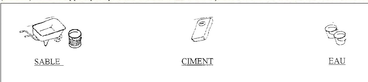
Enfin, on utilise le mortier dosé à 300 Kg/m<sup>3</sup> pour exécuter les enduits (2ème et 3ème couches). Cela se traduit par 3 brouettes de sable, 1 sac de ciment et 40 litres d'eau.
